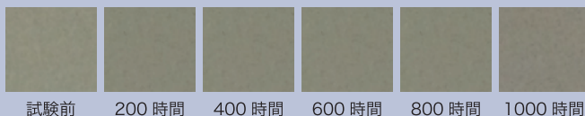
ロングタイプのキャップと同素材のプレートにて実施
